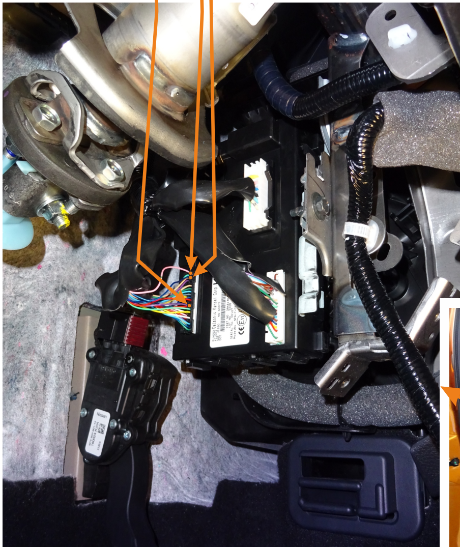
KOLEJNO PODŁ. CZANIA PRZEWODÓW: MASA, +12V, CANL, CANH ...
